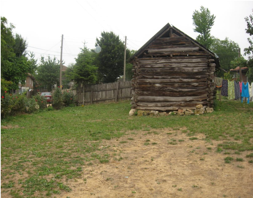
Resim: Pazarcık Köyünden Çandı Sistemi İle Yapılmış Bir Kütük damı (samanhane)
